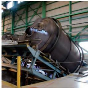
スイコーの大型容器はオランダ・ハッセンシューメーカー社が開発した回転成形技術（エンゲルプロセス）を用いて生産されています。
